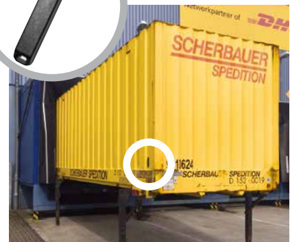
Auch die Wechselbrücken haben einen Transponder erhalten.
