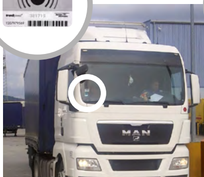
Die Scheibentransponder kommunizieren mit dem Leser.
